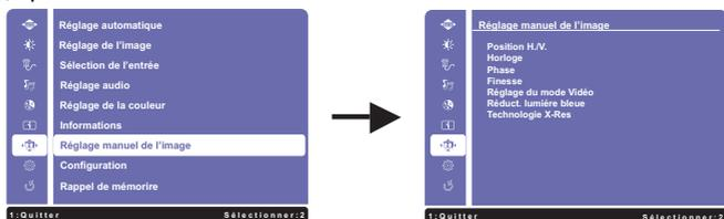
Une page d'ajustement apparaît après l'appui sur la touche [2]. Puis, sélectionnez Position V. en utilisant les touches ▲ / ▼. Appuyez la touche [2] à nouveau. Utilisez ensuite les touches ▲ / ▼ pour corriger la position verticale. La position verticale de l'image entière doit changer pendant que vous effectuez l'opération.
