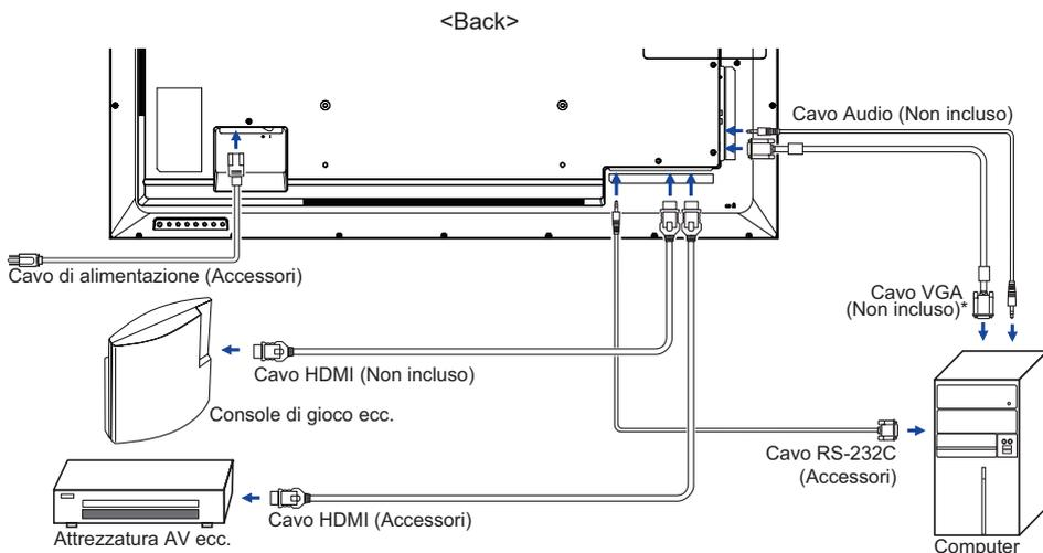
\* Il cavo VGA non è fornito con il monitor. Se usate un cavo VGA di scarsa qualità si potrebbero avere interferenze elettromagnetiche. Si prega di contattare il Centro di Supporto di Iiyama nel vostro paese se si desidera collegare il monitor tramite l'ingresso VGA.
