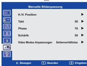
Eine Einstellungen erscheint nach dem Drücken der ② -Taste. Wählen Sie V. Position mit den Tasten ▲ / ▼. Drücken Sie erneut auf die ② -Taste. Verwenden Sie dann die Tasten ▲ / ▼, um die Einstellungen für die vertikale Position zu ändern. Hierbei sollte die vertikale Position der allgemeinen Anzeige ebenfalls entsprechend angepasst werden.
