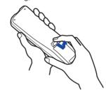
2 Legen Sie die zwei AAA Batterien ein. Achten sie beim Einlegen auf die angezeigte Polarität in der Fernbedienung.
