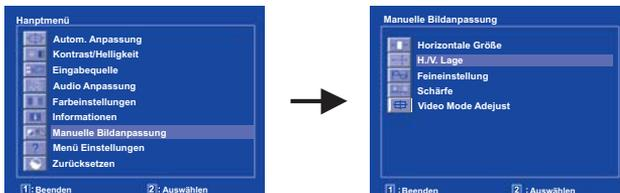
Eine Einstellung erscheint nach dem Drücken der ② -Taste. Wählen Sie V. Lage mit den Tasten ▲ / ▼. Drücken Sie erneut auf die ② -Taste. Verwenden Sie dann die Tasten ▲ / ▼, um die Einstellungen für die vertikale Position zu ändern. Hierbei sollte die vertikale Position der allgemeinen Anzeige ebenfalls entsprechend angepasst werden.
